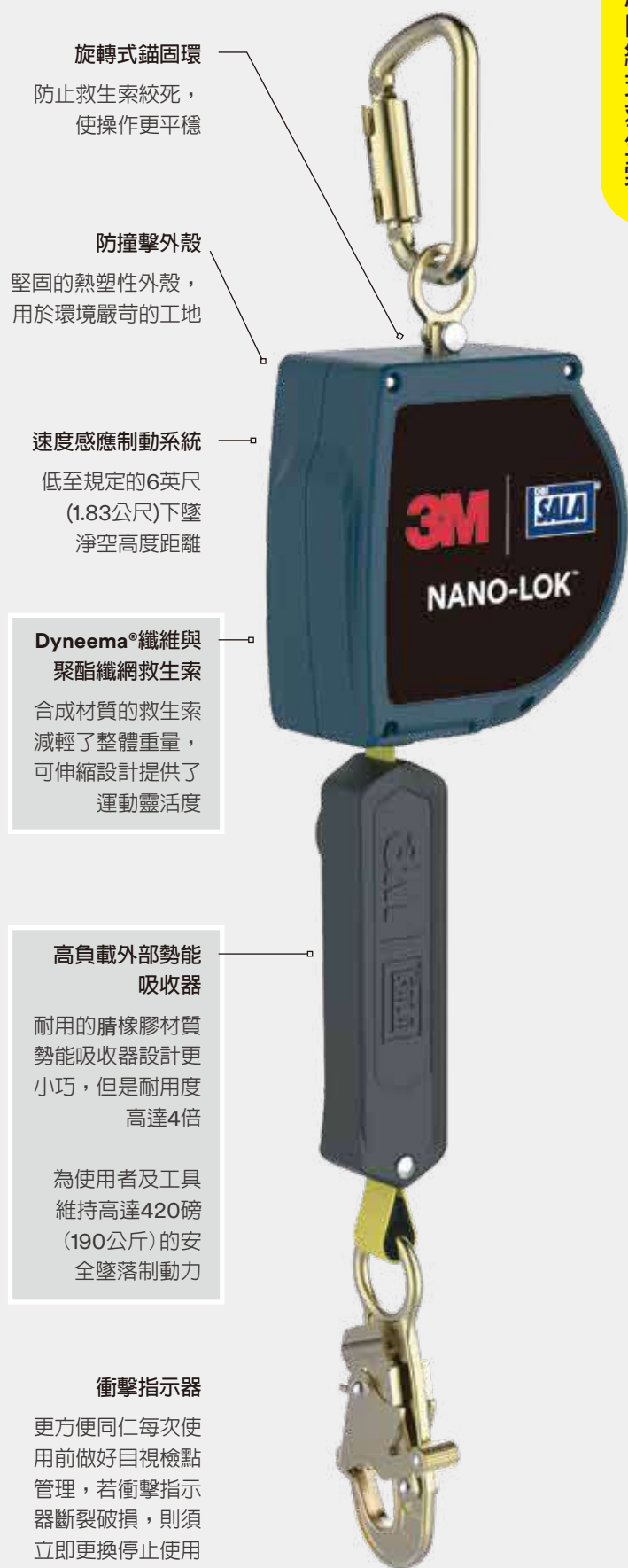
20英尺(6.10公尺) Nano-Lok 輕量型自動回縮救生索
